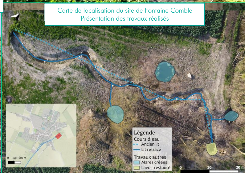
Jusqu'à-là rectiligne, le Comprigny a fait l'objet d'un reméandrage en 2021
